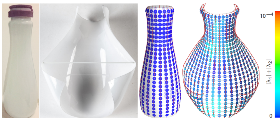
图 4.17: 等距变形塑料瓶及其模拟效果.
