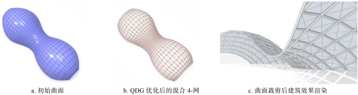
图 9 基于旋转面的曲面屋顶优化与设计
