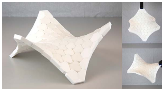
图 13 基于几何互锁的砌体结构 [102]
