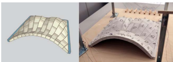
图 12 自支撑砌体结构 [100]
